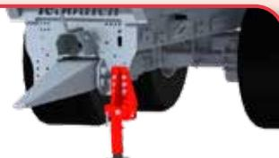
**Hydraulisch einklappbarer Stützfuß**, der direkt am Fahrgestell befestigt ist, um die Deichsel freizugeben und den Lenkeinschlag zu begünstigen
