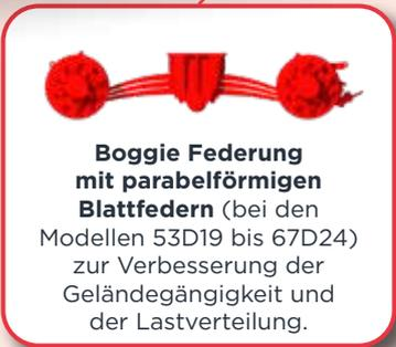
**Boggie Federung mit parabelförmigen Blattfedern** (bei den Modellen 53D19 bis 67D24) zur Verbesserung der Geländegängigkeit und der Lastverteilung.
