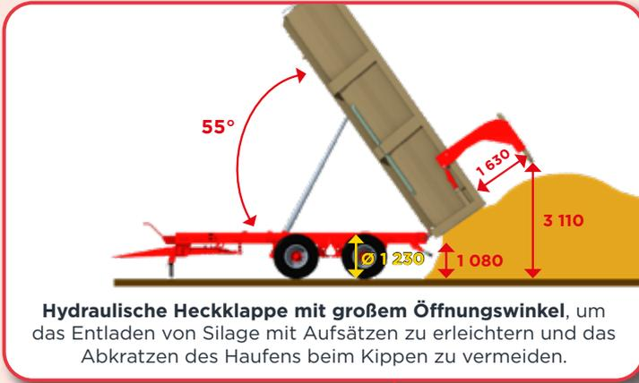
**Hydraulische Heckklappe mit großem Öffnungswinkel**, um das Entladen von Silage mit Aufsätzen zu erleichtern und das Abkratzen des Haufens beim Kippen zu vermeiden.
