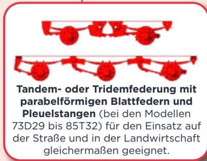
**Tandem- oder Tridemfederung mit parabelförmigen Blattfedern und Pleuelstangen** (bei den Modellen 73D29 bis 85T32) für den Einsatz auf der Straße und in der Landwirtschaft gleichermaßen geeignet.
