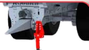
**Béquille hydraulique repliable** fixée directement au châssis de la benne pour libérer le timon et favoriser le braquage.
