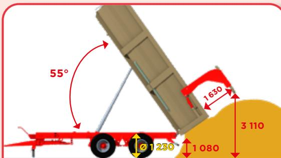
**Porte arrière à grand dégagement avec ouverture hydraulique** pour faciliter le déchargement de l'ensilage avec rehausses et éviter le raclage du tas lors du bennage max.
