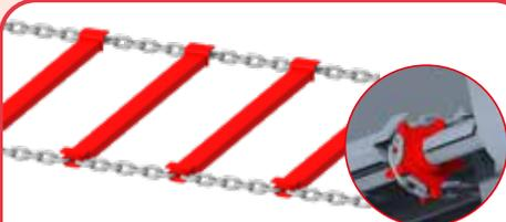
**Barrettes en tubes soudées aux chaînes marines 14** (pour éviter le stockage de matière) + noix d'entraînement mécanosoudées.
