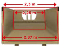
**Caisse conique** (2,25 m à l'avant et 2,3 m à l'arrière) et plus large en bas qu'en haut pour faciliter le déchargement de la matière.
